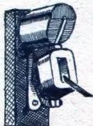
Das Bild rechts oben veranschaulicht das Zusammenwirken von Lampe u. Meßsystem. Das Meßsystem ist hier in Ruhestellung. Dem entspricht eine volle Ausleuchtung des Gehäuseausschnittes. Bewegt sich der Zeiger aus der Endstellung, so wird ein mehr oder minder größerer Teil des Lichtstreifens abgedeckt.
