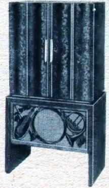
Ein 9-Röhren-Super mit allen Schikanen, zwei Lautsprechern, zwei getrennten Endverstärkerteilen, elektrischem Lautwerk und 12 Watt Ausgangsleistung. Preis ca. RM. 900.— (Werkphoto La Voce del Padrone)
